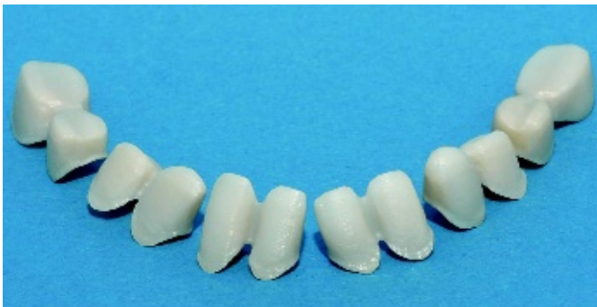
Abb. 22 Yttriumstabilisierte Zirkoniumdioxid-Caps, paarweise hergestellt.
